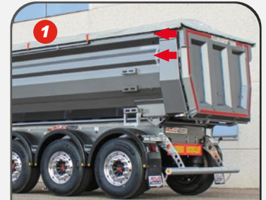
Double longitudinal stiffener
