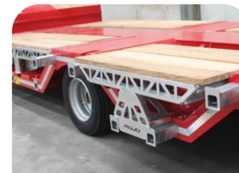
Side widening Ensanchamiento lateral Elargissement latéral
